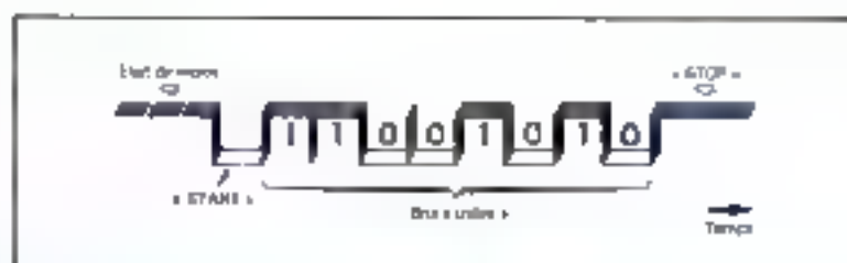
Fig. 1. — Trame de transmission en onde carrée. Les bits sont représentés par des sauts de niveau.
